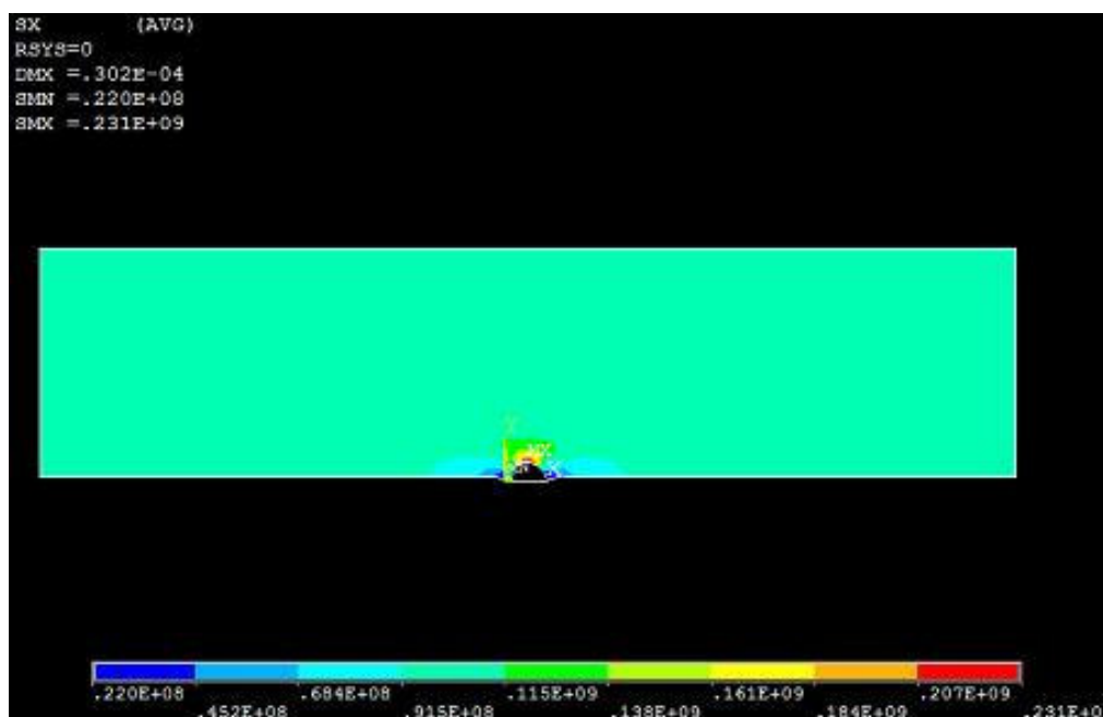
Рисунок 3 – Результаты расчетов для напряжения \sigma_X
